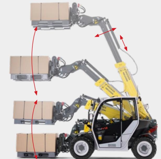
Mit starker Highflow-Hydraulik (bis 100 l/min) und 5,47 m Hubhöhe ist der TH522 das Multitool für ein breites Einsatzspektrum
